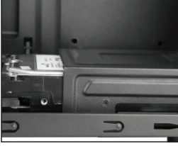
3- Sürücüyü yukarıdaki resimde gösterildiği gibi vidayla kasa gövdesine sabitleyin
