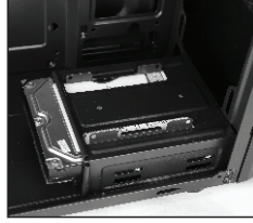
2- İsteddiğiniz sürücüyü bölmeye koyun 3,5 inç yerleştirin
