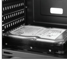
2- Yukarıdaki resimdeki gibi 3,5 inç sürücü gösterilen yere yerleştirin
